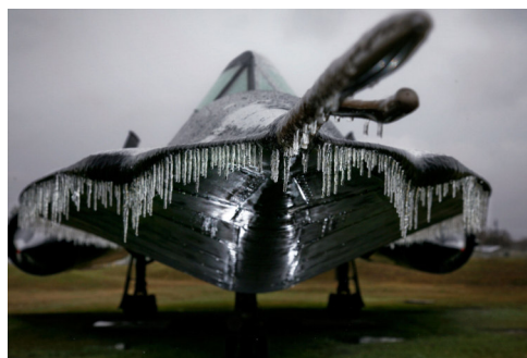
Givrage au sol
